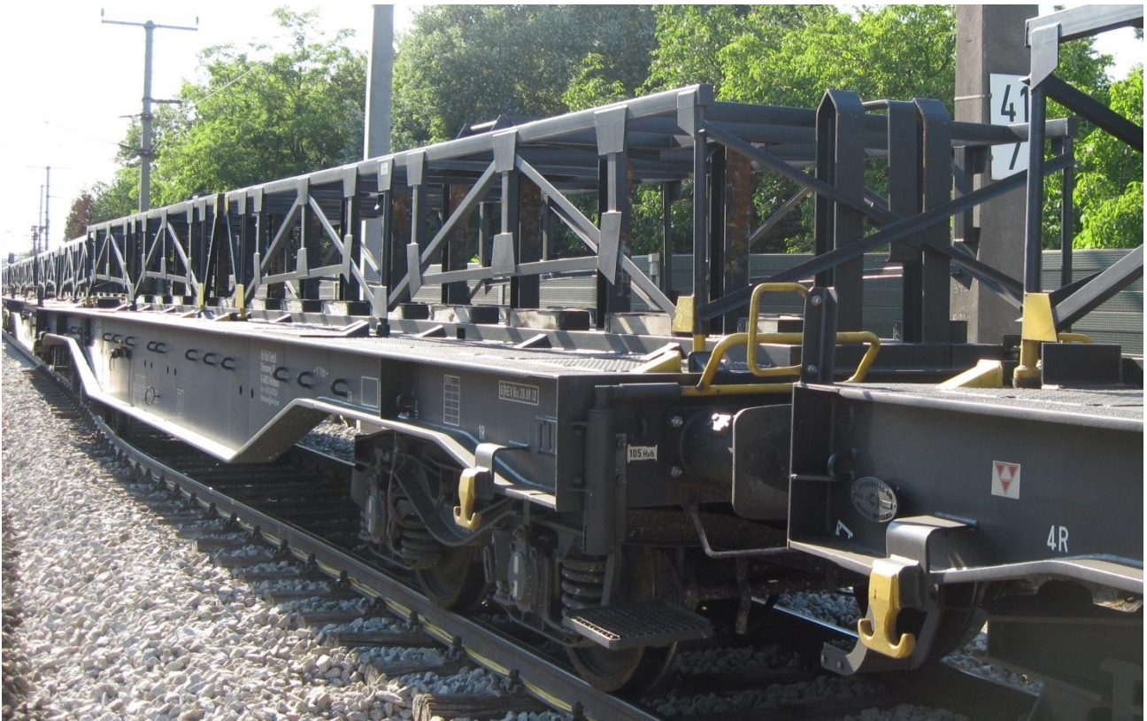
Abbildung 22 Wagen der Gattung Smnps, nicht entgleist (Quelle IM)
