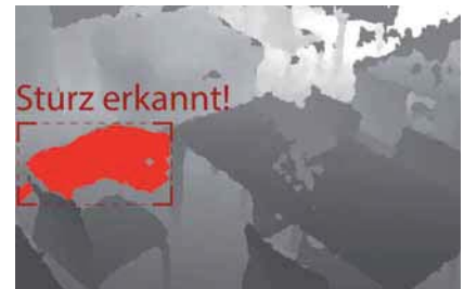
FEARLESS ermöglicht es, Stürze zu erkennen.
