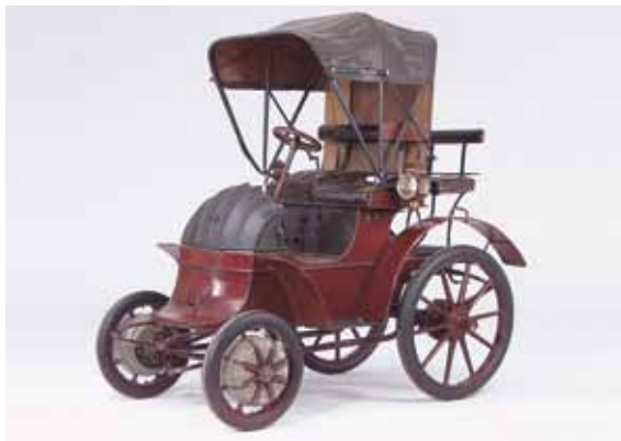
Lohner-Porsche mit Radnaben-Elektromotoren. Foto: Technisches Museum Wien
