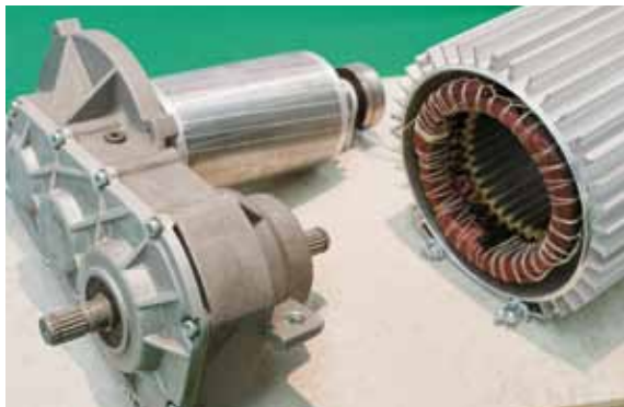
In dem feststehenden Stator (rechts) dreht sich der Rotor (oben mitte). Foto: Bill Lorenz
