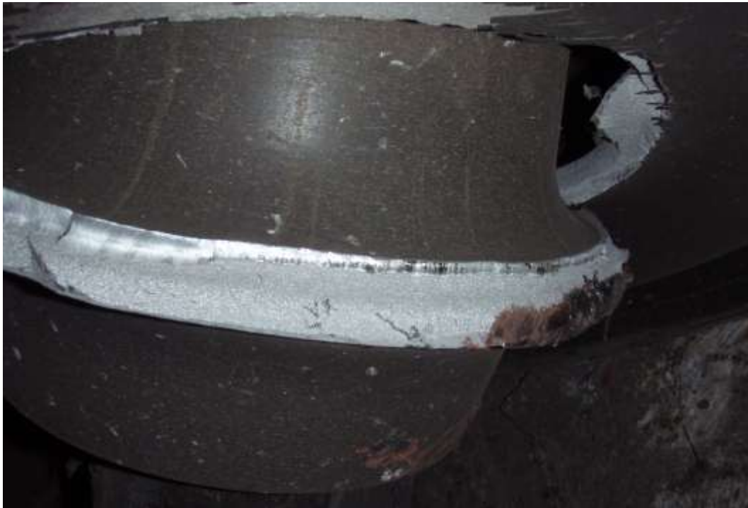
Abbildung 25 Gebrochene Radscheibe von RS 4 (I. RS in Fahrtrichtung)
