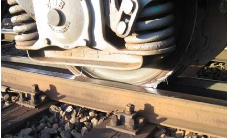
Abbildung 19 Entgleister vorlaufender Radsatz des 23. Wagens - Quelle IM
