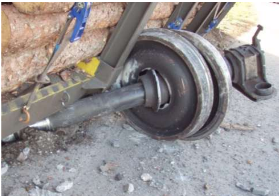
Abbildung 10 Beschädigter Radsatz des 19. Wagens
