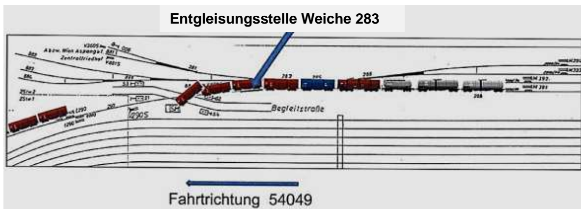
Abbildung 11 Schematische Darstellung der Entgleisung - Quelle IM
