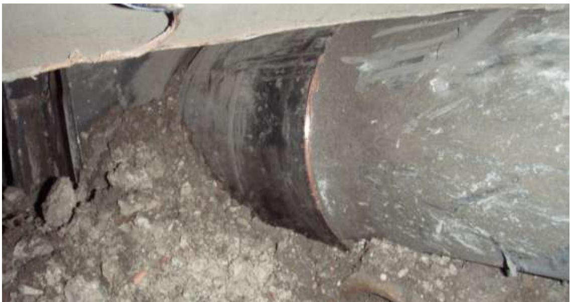
Abbildung 24 Radscheibensitz von RS 4 (I. RS in Fahrtrichtung) im Schotterbett
