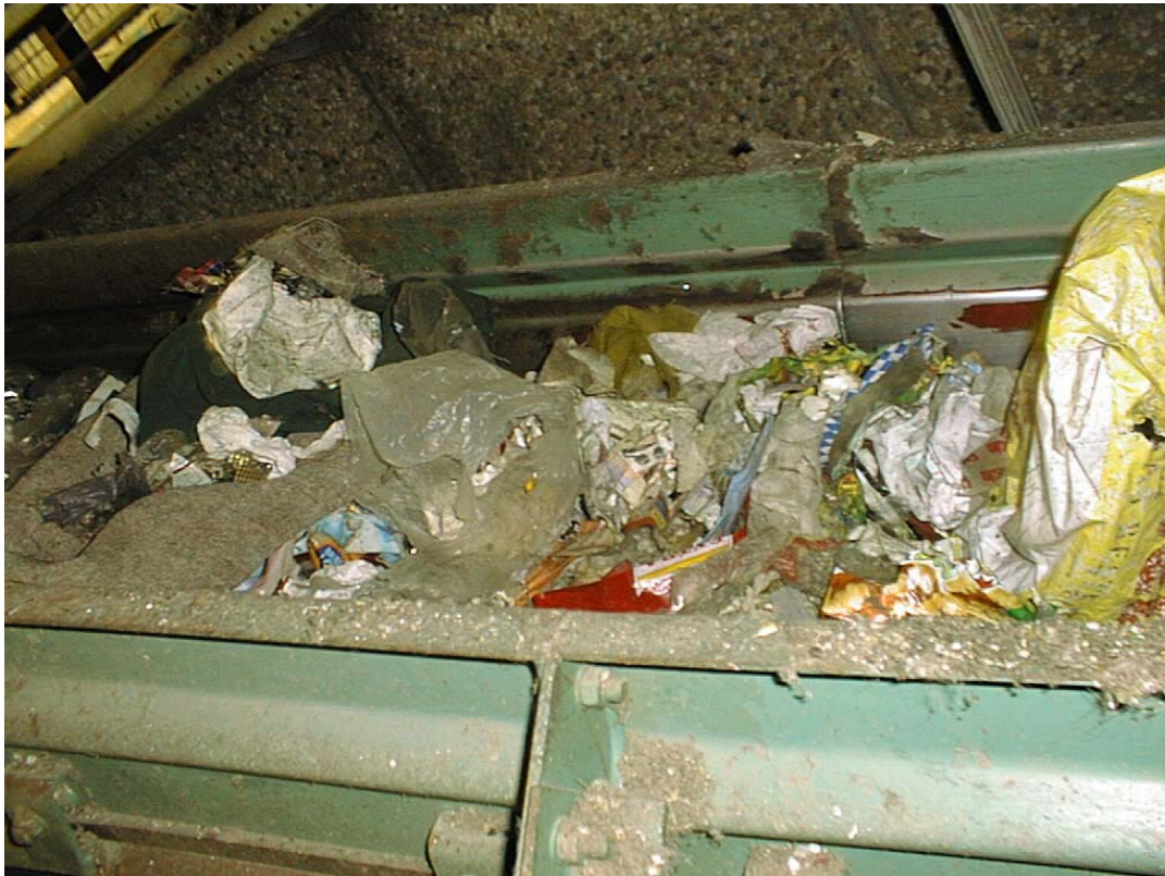
Abbildung 6.5: ZEMKA Fraktion >100mm, Förderband zur Verladung [10.02.2003, 14:23]
