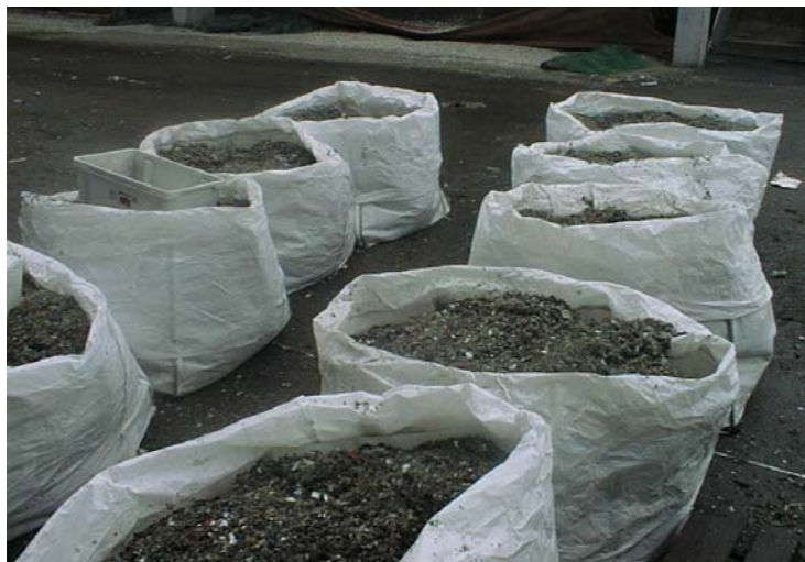
Abbildung 6.14: Big Bags als Probengefäß
