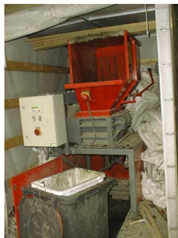
Abbildung 7.7: zweiter Verjüngungsschritt im Auswurf des Doppelwellenzerkleinerers
