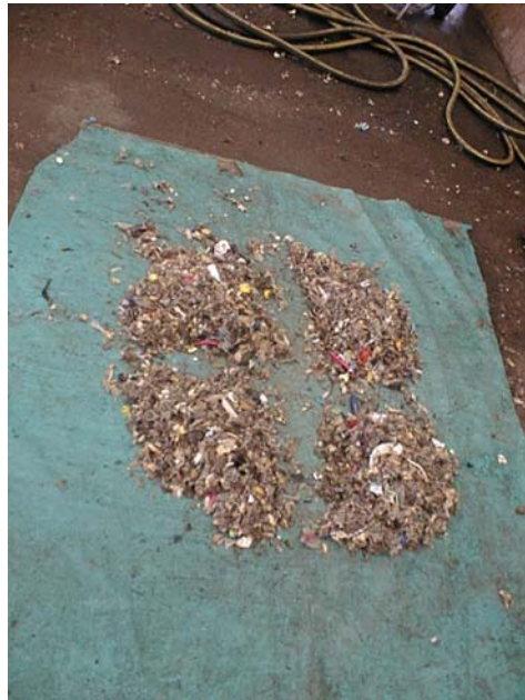
Abbildung 8.16: Viertelteilung beim Versuch Thöni
