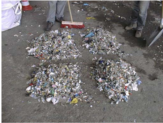
Abbildung 9.6: Viertelteilung auf gekehrtem, trockenem Betonboden
