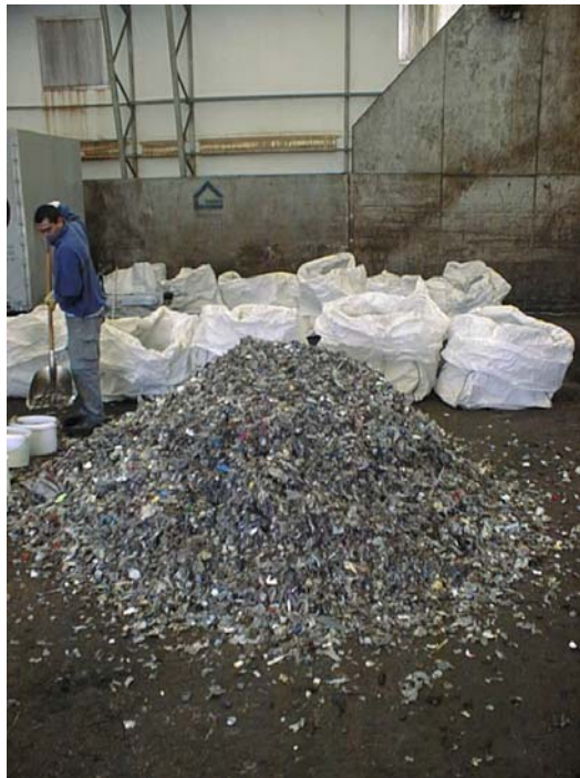
Abbildung 8.8: Entnahme von Einzelproben (10 l) aus der Teilprobe (3-4m 3 ) und Herstellung der Sammel-/ Mischproben (200 l) auf feuchtem Hallenboden
