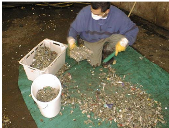
Abbildung 8.13: Fraktionales Schaufeln – letzter Verjüngungsschritt
