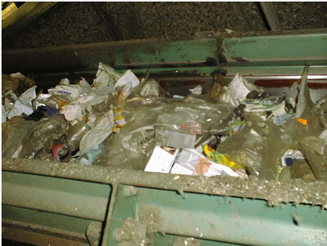
Abbildung 6.6: ZEMKA Fraktion >100mm, Förderband zur Verladung [10.02.2003, 14:25]
