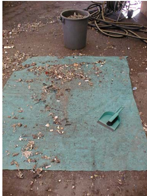
Abbildung 8.14: auch der Feinanteil wurde der Probe bei der Teilung 1:2 zugegeben
