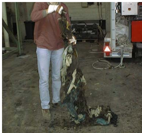
Abbildung 7.9: Das lange Mischen in der Trommel führt zur Bildung von „Zöpfen“
