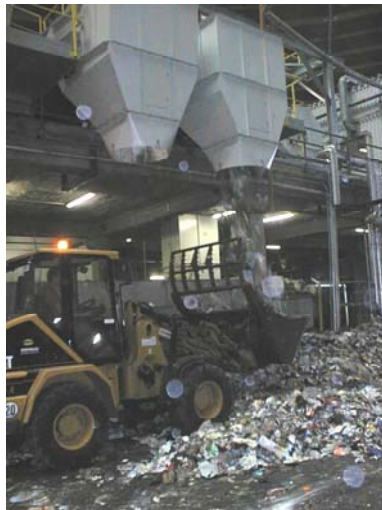
Abbildung 9.1: Probenahme vom Abwurf der Splittinganlageanlage Rinterzelt
