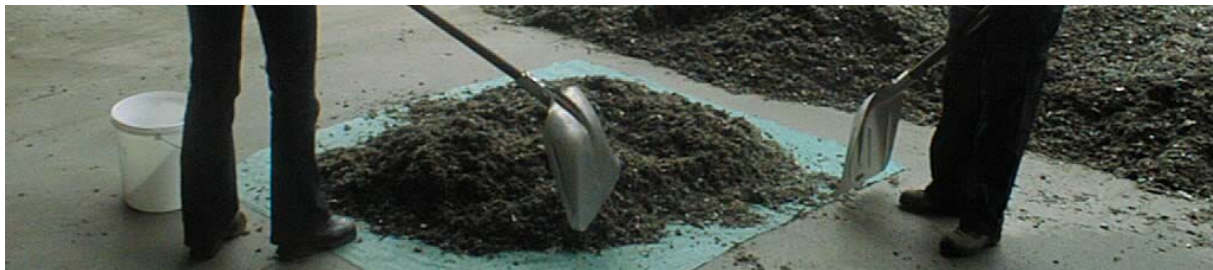
Abbildung 6.16: Viertelteilung auf Unterlage
