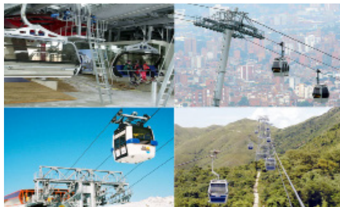
Vier Beispiele für Seilbahnsysteme der Gruppe A: Sesselbahn (li. oben) – Einseilumlaufbahn (re. oben) – Doppeleinseilumlaufbahn (li. unten) – Zweiseilumlaufbahn (re. unten)
