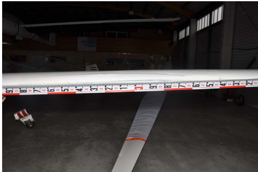
Bild 8: Darstellung DG 300 linke Tragfläche, Beschädigung Nasenbereich Quelle: SUB, LKA Vorarlberg
