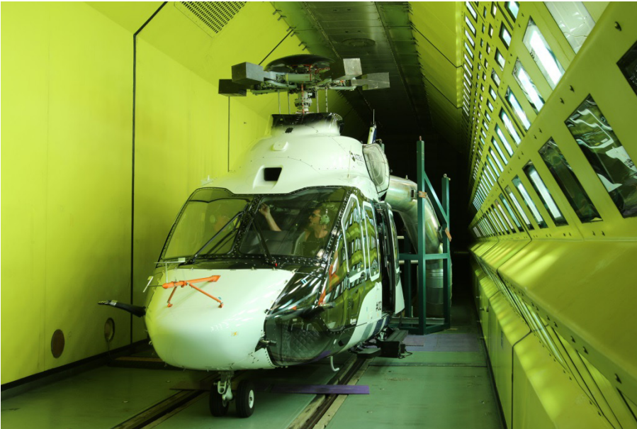
Abbildung 2: Der IWT in Wien erlaubt Vereisungstests bis zu einer Geschwindigkeit von knapp 300 km/h bei einem Vereisungsquerschnitt von 8,75 m 2 , Quelle: Rail Tec Arsenal
