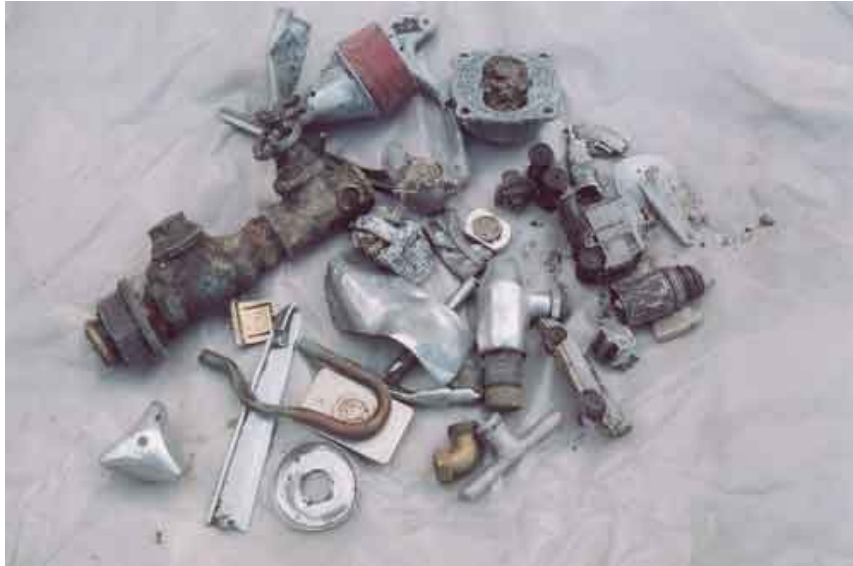
Abbildung 3-33: Aussortierte „Konzentrat“ aus einer NFe-Schrotprobe von der Wirbelstromabscheidung der MBA Oberpullendorf. In dieser Fraktion sind alle Gegenstände gesammelt, die Schwermetalle in hoch konzentrierter Form enthalten.
