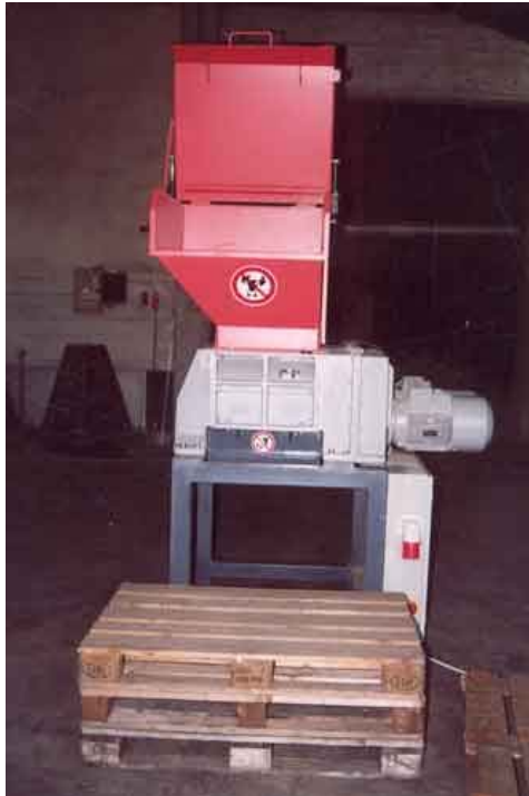
Abbildung 3-22 a und b: UNTHA RS 30 Vierwellenzerkleinerer für den Einsatz mit verschiedenen Lochgittern, 22kW Nennleistung; links: Gesamtansicht, rechts: Ansicht des Schneidwerks
