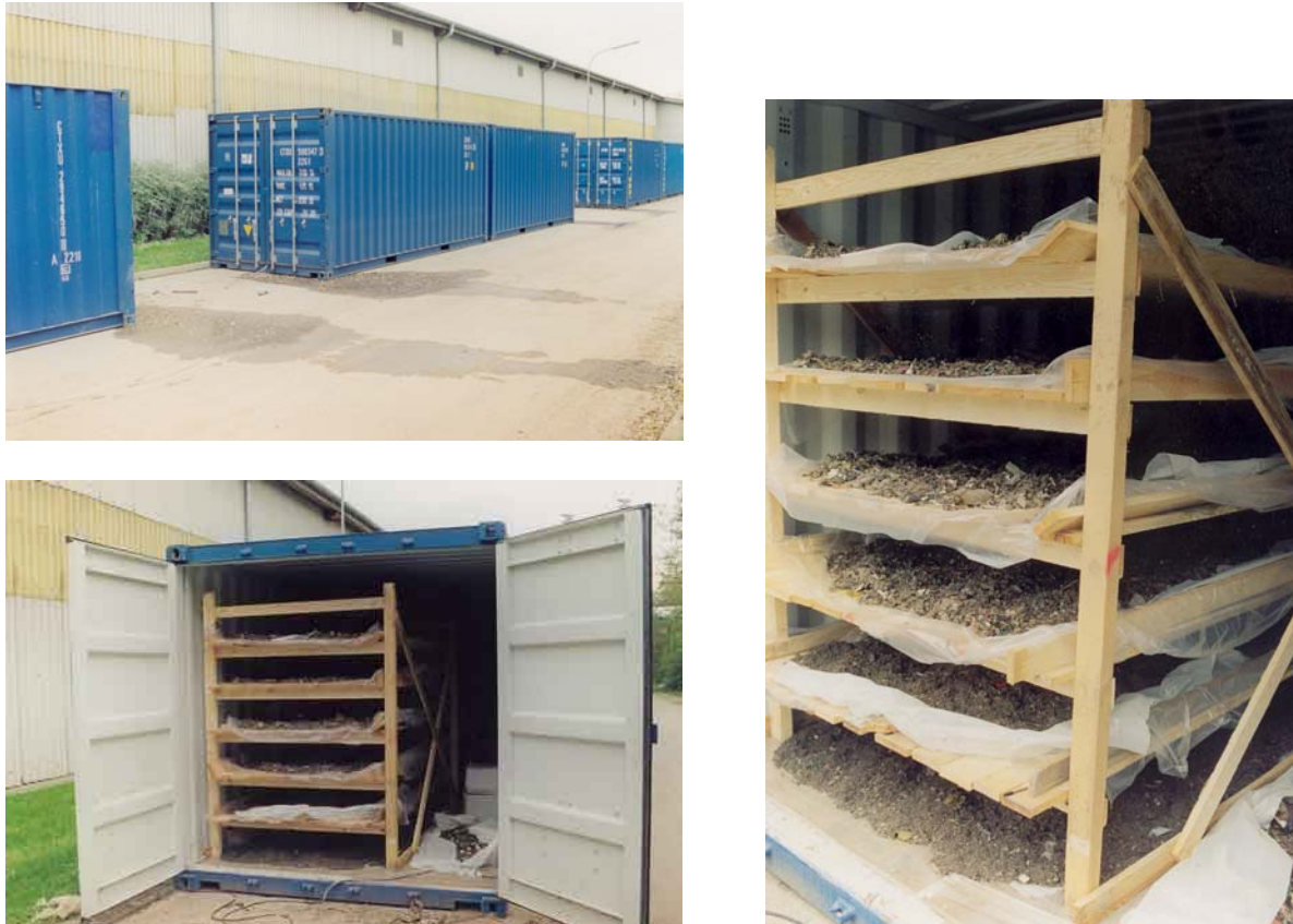
Abbildung 3-25: 20' Lagercontainer zur Probentrocknung. Links oben: Aufstellung der Container beim Versuch in Oberpullendorf, im Vordergrund ablaufendes Kondenswasser der Entfeuchtungsgeräte; unten links und rechts: Ansicht der eingebauten Stellagen
