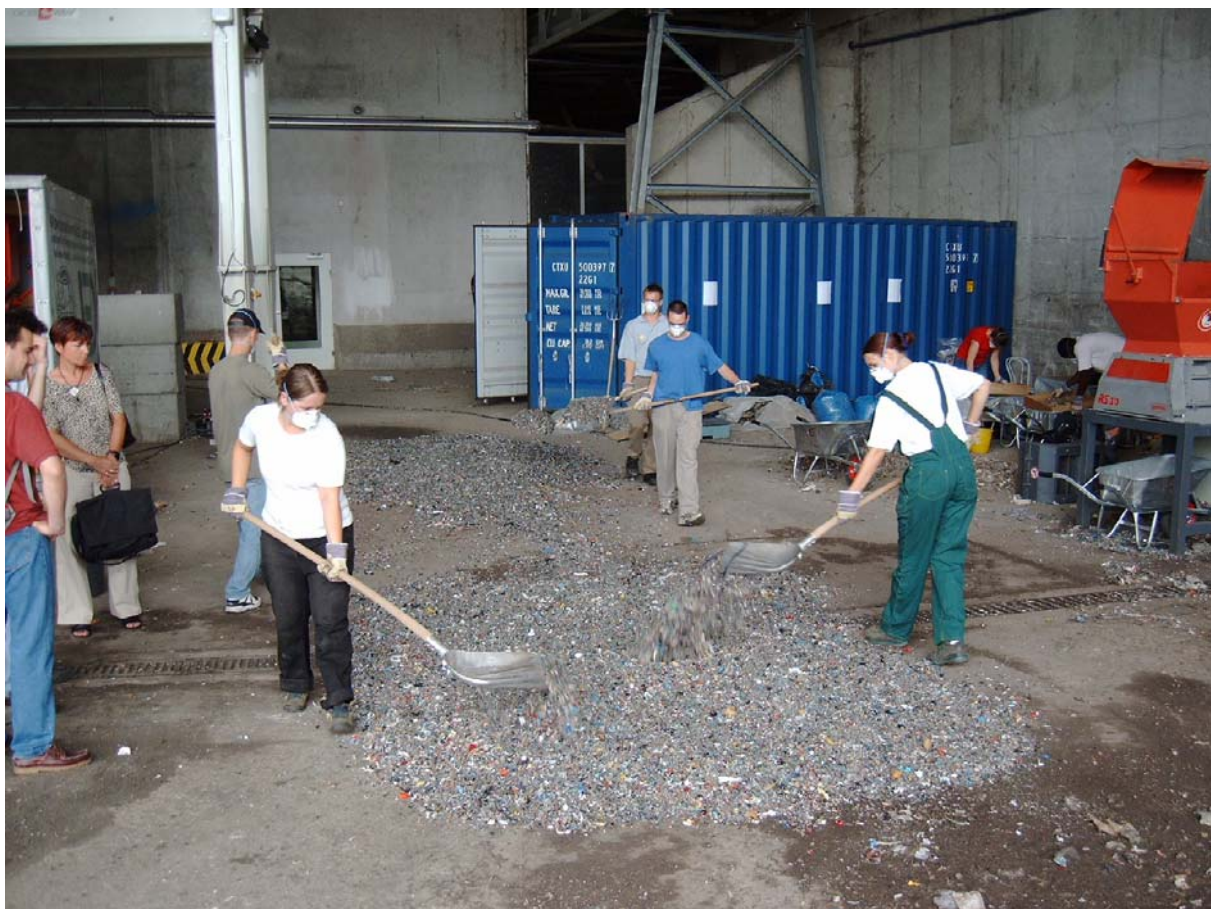
Abbildung 3-24: Zweiter Durchgang des Aufschichtens einer Probe zur Teilung (Foto: Christian Rolland, mit freundlicher Genehmigung)
