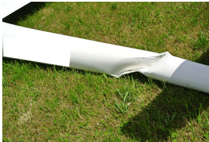
Bruchstelle der Rumpfröhre bei Seitenleitwerk
