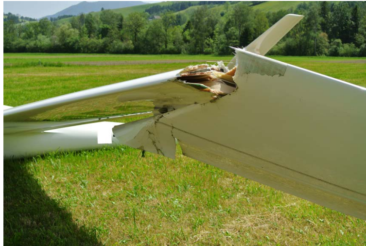
Bruchstelle linke Tragfläche
