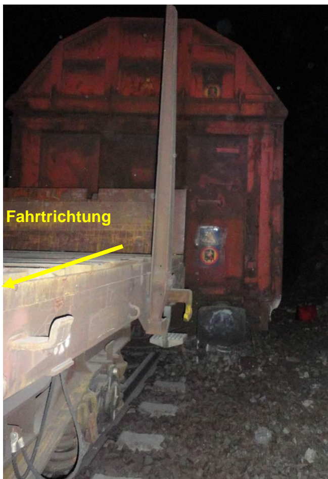
Abbildung 8 Entgleister 18. Wagen 31 80 593 1 619-6- Quelle IM
