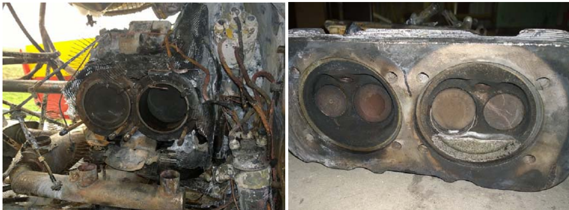
Abb. 2 Zustand der rechten Zylinder 3 und 4 nach Demontage des Zylinderkopfs; Zustand des rechten Zylinderkopfs 3/4, S/N 1057 (Quelle: HB-Flugtechnik GesmbH).
