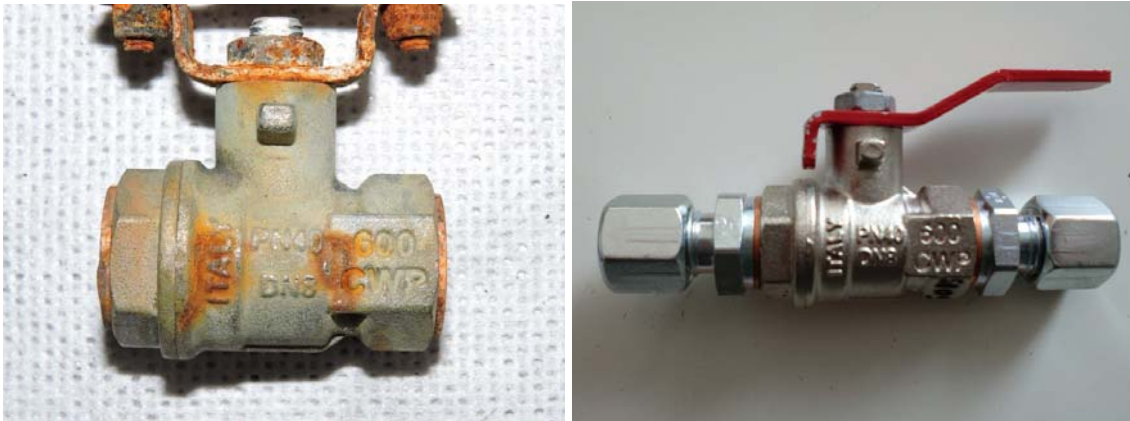
Abb. 1 Zum Zeitpunkt des Vorfalles im Motorsegler eingebauter Brandhahn (Kugelventil ohne Fertigungsnummer; Quelle: SUB); Kugelventil ARGUS Typ NK Baureihe 490 P/N 11003 (Kugelventil mit Fertigungsnummer; Quelle: Scheibe-Aircraft-GmbH)
