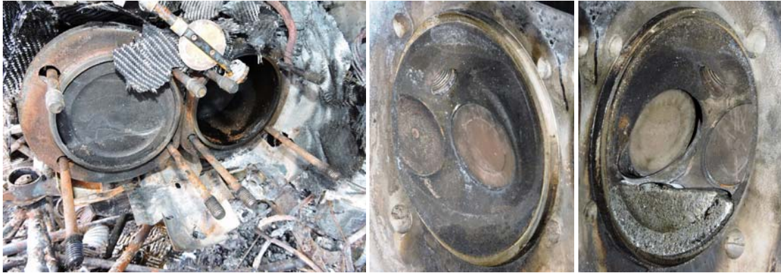
Abb. Kolbenboden von Zylinder 3 (links) mit sichelförmiger Einschlagmarke; intakter Ventilsitz am Zylinder 4; Aus- und Einlassventil von Zylinder 4; defekter Ventilsitzring am Einlassventil von Zylinder 3 und erkaltete Aluminiumschmelze im Hohlraum zwischen Kolbenboden von Zylinder 3 und Zylinderkopf 3/4 (Quelle: SUB).
