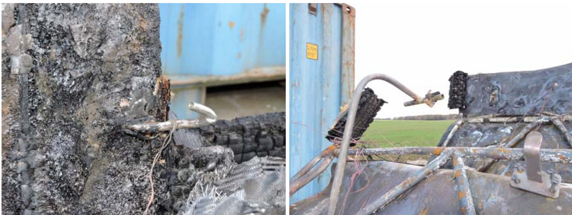
Abb. 4 Kraftstoffleitung des rechten Flügeltanks; Kraftstoffsammelleitung von den Flügeltanks zum Brandhahn (Quelle: SUB).
