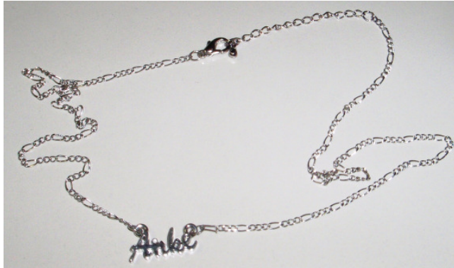
Abbildung 2: Die Namensplakette eines beanstandeten Schmuckstückes enthielt 33 % Cadmium, mehr als das Dreitausendfache des Grenzwertes.
