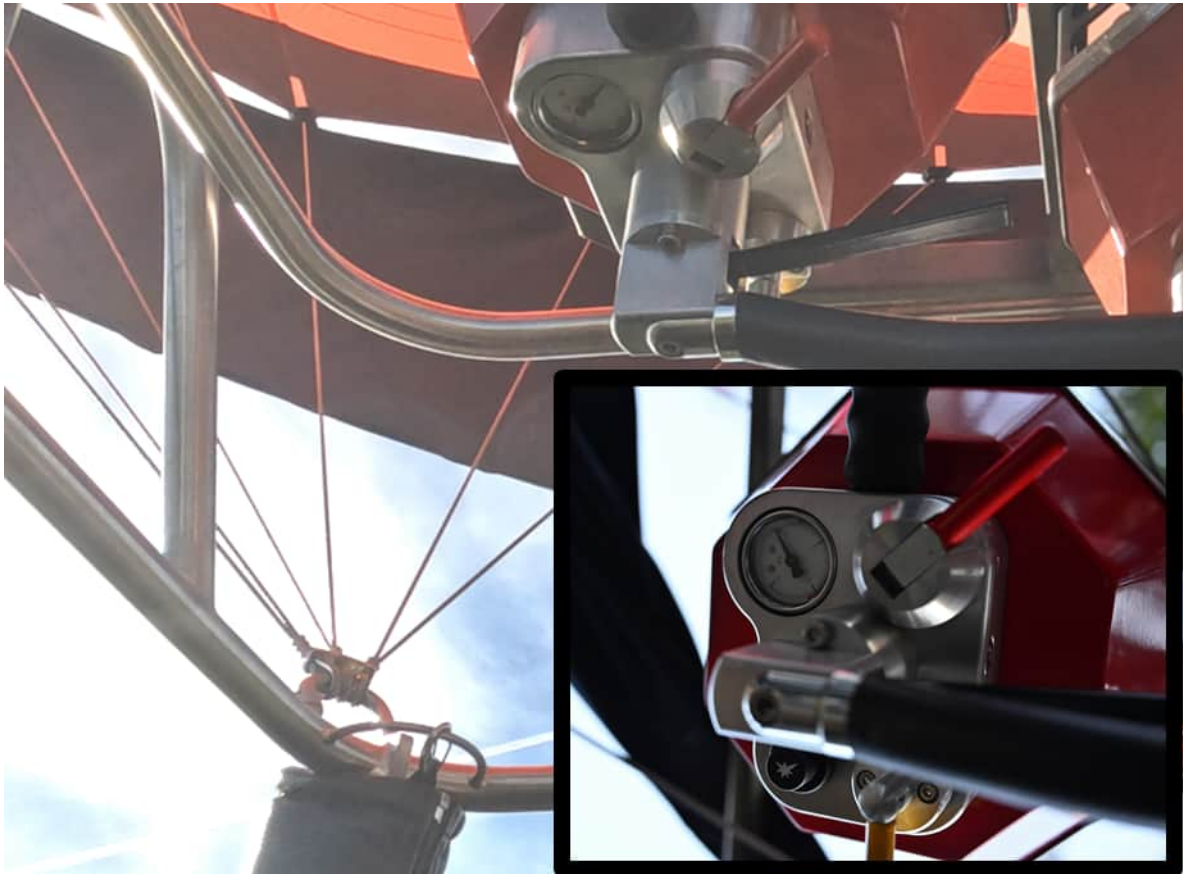
Abbildung 16 Manometer der Brenner kurz vor dem Unfall
